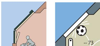
**VFE** – вертикальный фасадный элемент с открыванием по нижней оси. Управляется с помощью ручки, расположенной в верхней части фрамуги. VFE комбинируется с окнами GGL, GPL, GTL.
