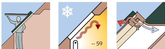
**Открывание:** по центральной оси. Ручка в верхней части окна позволяет установить окно на оптимальной высоте, а также разместить под окном мебель. Внешнюю поверхность окна легко мыть, находясь внутри помещения.
